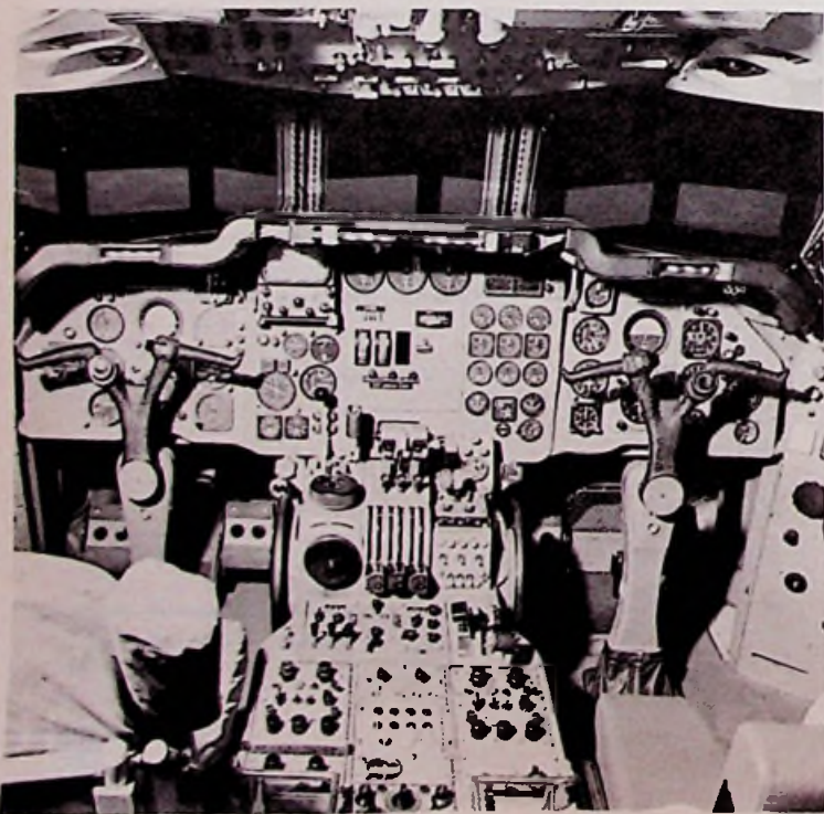
Afb. 15 Deel van de Trident cockpit. In het midden, direct onder de drie gas-handles, het bedieningspaneel van afb. 14.
